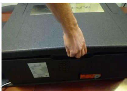
Atsargiai atidarykite įrenginio dureles, darydami iš vienos pusės. Pradėkite nuo laidų įėjimo pusės.
