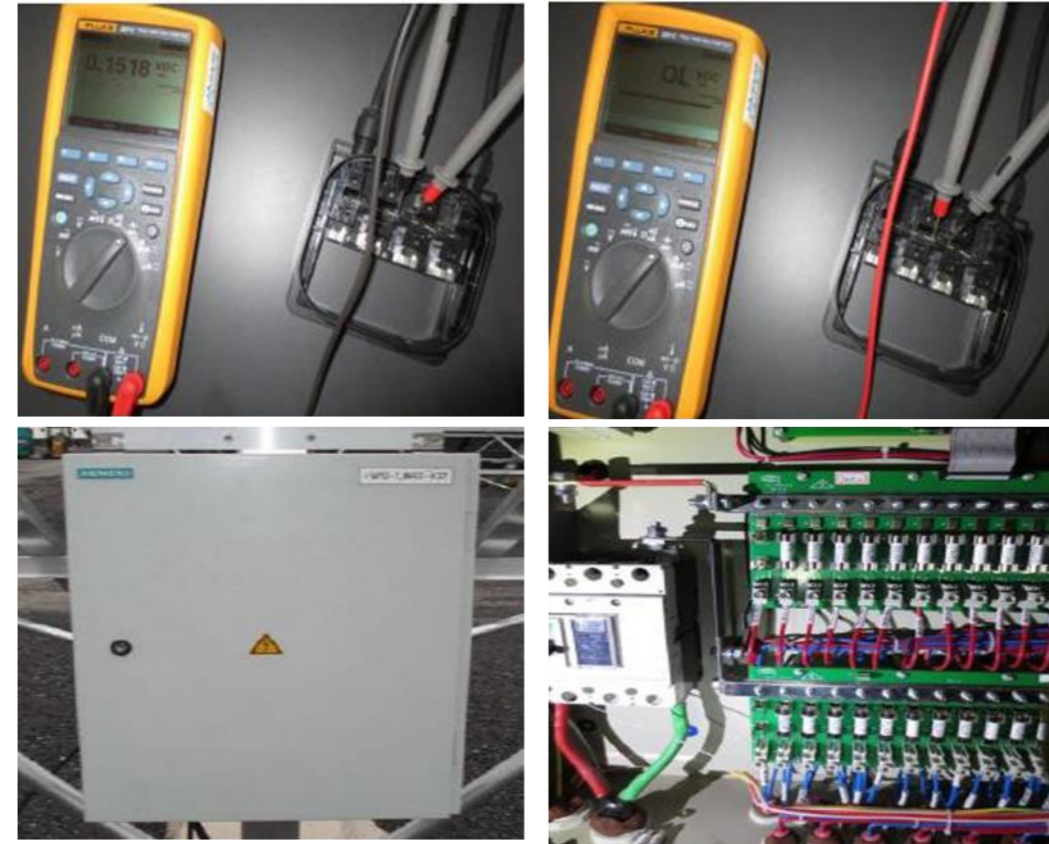
Prietaisai Riso, Voc, I-V kreivių matavimui
